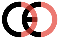
Falsche CE-Kennzeichnung (zu dicht)
