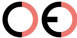
Falsche CE-Kennzeichnung (zu großer Zwischenraum)
